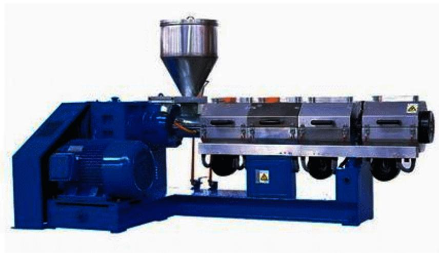
La máquina extrusora de un solo tornillo principalmente se compone de tres partes: sistema de extrusión, sistema de transmisión y sistema de calefacción y refrigeración. Estas tres partes se describen en detalle a continuación.
