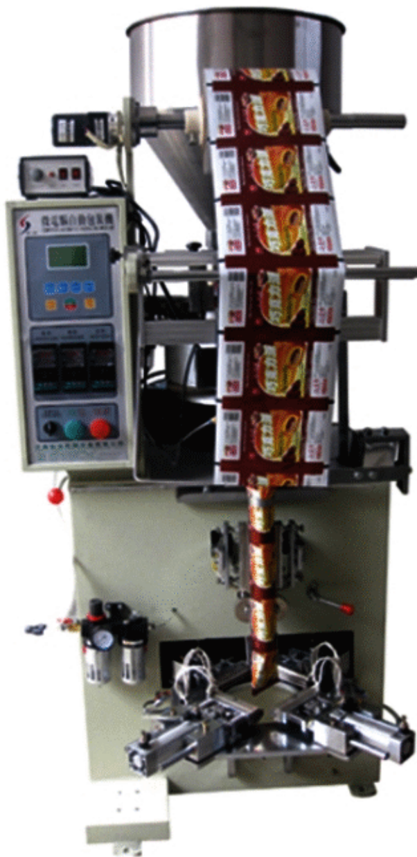
IMAGEN DE DETALLE DE LA LÍNEA DE EMBALAJE DE GRÁNULOS
