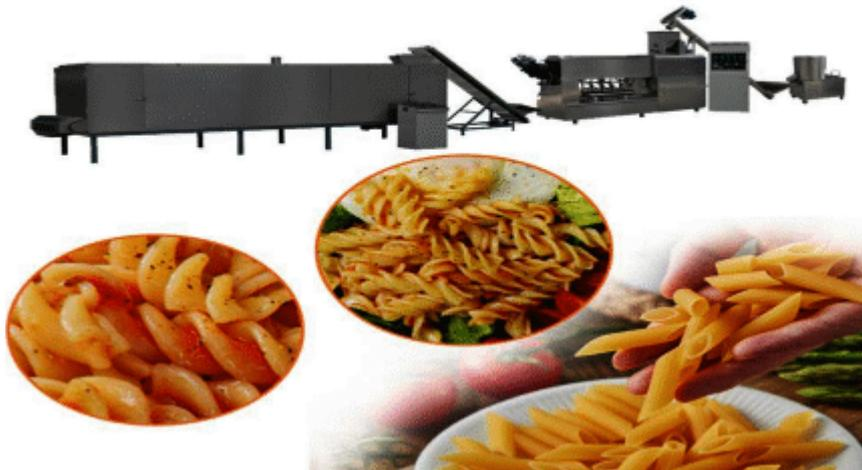
3). Se caracteriza por técnicas únicas, configuración racional y rendimiento estable. La máquina de macarrones puede terminar de madurar, extruir y dar forma en un solo paso sin caldera. Los productos tienen un color brillante, suave y agradable, y tienen un sabor delicioso después de la cocción. La pasta no se romperá hervida en agua hirviendo durante 45 minutos (probado).
