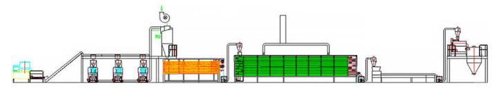
MISTURADOR DE FARINHA - TRANSPORTADORA DE PARAFUSO - EXTRUSOR DE PARAFUSO DUPLO COM SISTEMA DE REFRIGERAÇÃO - REFRIGERADOR DE VIBRAÇÃO - TRANSPORTADORA DE AR ??- ROLO DE SECAGEM - TRANSPORTADORA DE AR ??- MÁQUINA DE SECAGEM - TRANSPORTADORA DE REFRIGERAÇÃO
