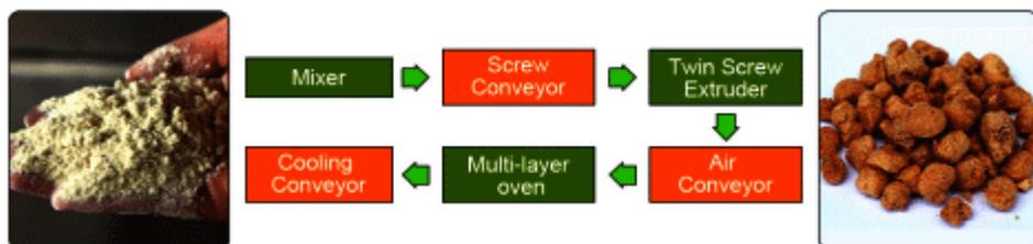
Misturador-Rosca Transportadora-Extrusora De Rosca Dupla- Transportadora de Ar- Secadora-Hoister- Máquina de Aromatização
